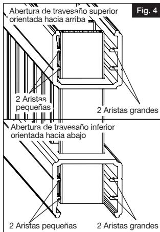
b. Insertar los barrotes en los orificios cuadrados en los travesaños superior e inferior, comprobando que los orificios en los barrotes apunten en la misma dirección hacia el lado con las dos (2) aristas pequeñas (Fig. 5).
